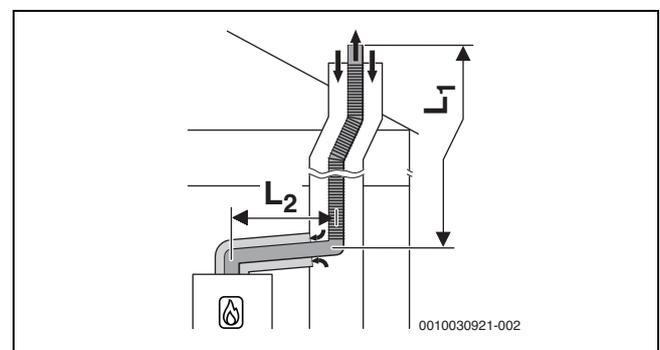
Fig. 11 Evacuation des fumées flexible selon C<sub>93</sub> dans le conduit et circuit d'air et de fumées concentrique dans le local d'installation
