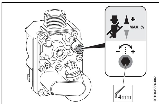
Fig. 40 Régler la teneur en CO<sub>2</sub> ou en O<sub>2</sub> pour la puissance thermique nominale maximale, vanne gaz ajustable
