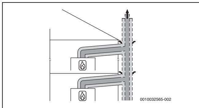
Fig. 17 Raccordement de plusieurs foyers selon  $C_{(12)3}$  avec circuit d'air et de fumées concentrique dans le local d'installation
