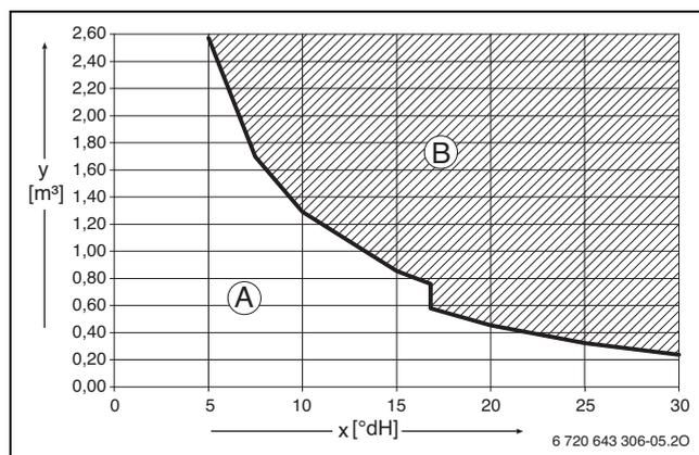
Fig. 19 Conditions requises pour l'eau de remplissage et d'appoint en °dH sur les appareils < 50 kW
