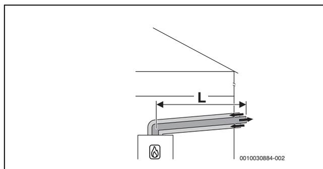
Fig. 8 Circuit d'air et de fumées concentrique horizontal selon C<sub>13</sub> par le mur extérieur
