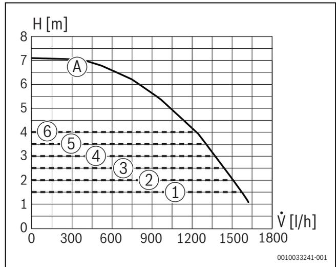
Fig. 78 Diagrammes de pompe et courbes caractéristiques de pompe
