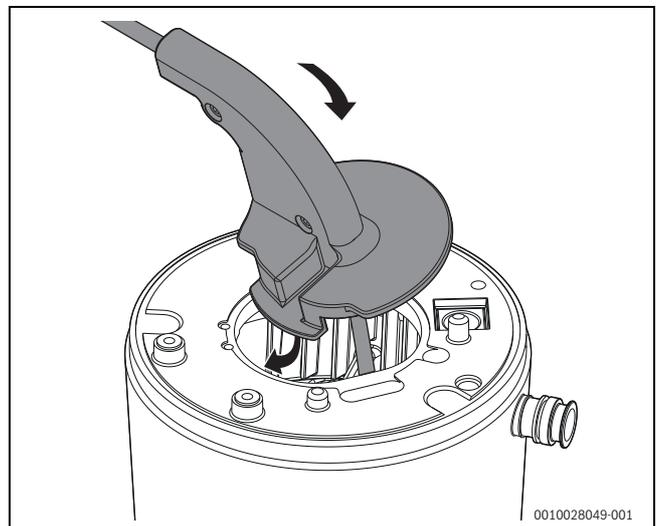
Fig. 53 Insertion de la brosse dans le corps de chauffe
