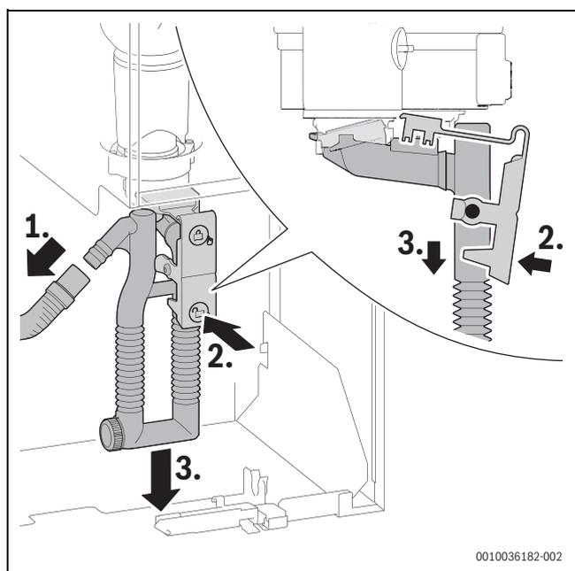
Fig. 58 Démontez le siphon des condensats
