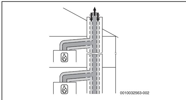
Fig. 14 Raccordement de plusieurs foyers selon C<sub>43</sub> avec circuit d'air et de fumées concentrique dans le local d'installation
