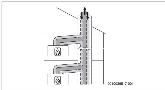
Fig. 15 Raccordement de plusieurs foyers selon C<sub>43p</sub> avec circuit d'air et de fumées concentrique dans le local d'installation
