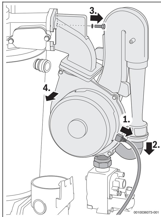
Fig. 47 Démontage du ventilateur avec le dispositif de mélange
