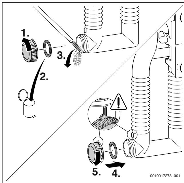
Fig. 59 Nettoyage du siphon de condensats
