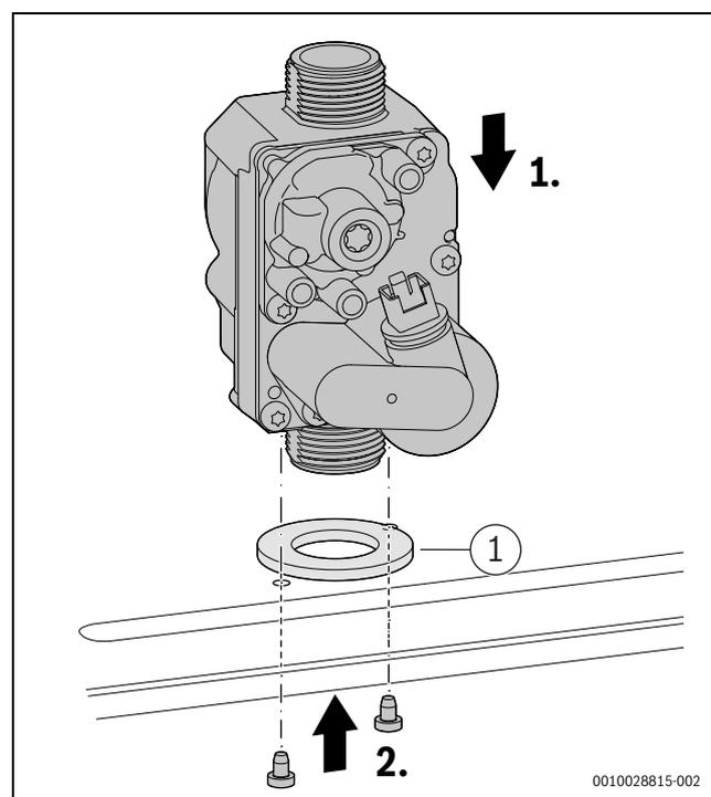
Fig. 70 Installation du bloc gaz
