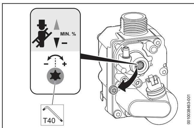
Fig. 42 Régler la teneur en CO<sub>2</sub> ou en O<sub>2</sub> pour la puissance thermique nominale minimale, vanne gaz fixe
