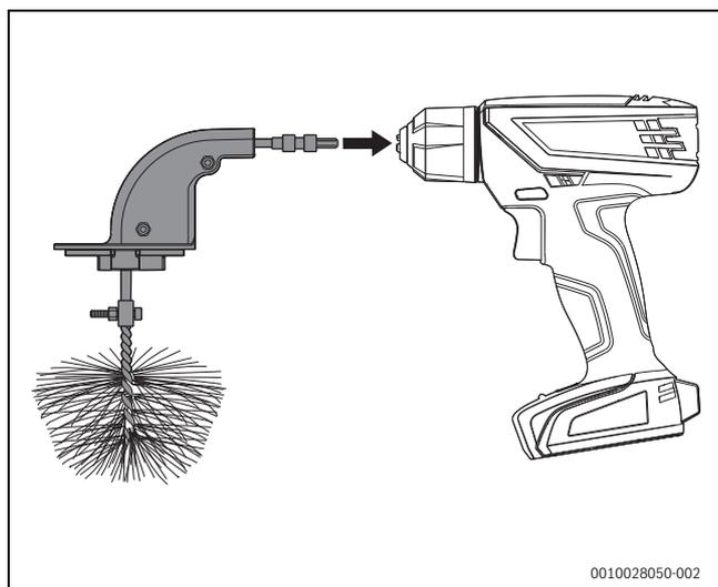
Fig. 54 Raccordement de la brosse à une visseuse sans fil
