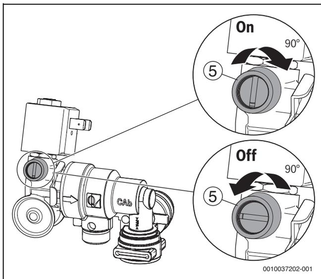
Fig. 31 Remplissage manuel avec le dispositif de remplissage automatique (accessoire)
