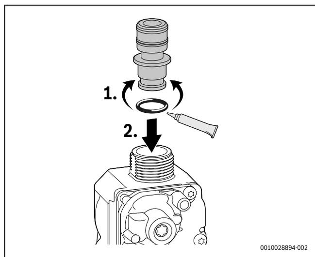
Fig. 72 Insertion du réglage de gaz
