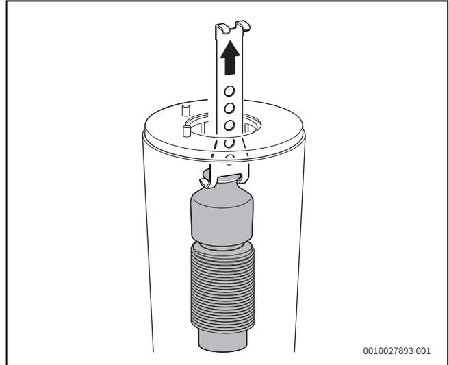
Fig. 51 Retirer le corps de déplacement supérieur
