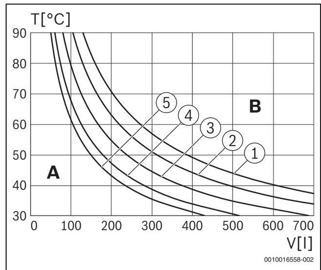
Fig. 21 Courbes caractéristiques du vase d'expansion
