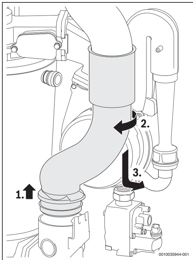
Fig. 46 Démontage du tuyau d'évacuation des fumées
