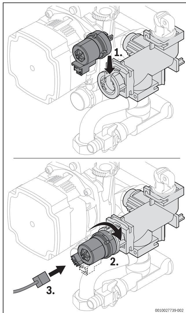
Fig. 75 Remontez le moteur au niveau de la vanne 3 voies (variante sans vis)
