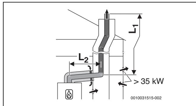
Fig. 13 Evacuation des fumées flexible dans le conduit selon B<sub>33</sub> avec arrivée d'air dépendant de l'air ambiant par le circuit d'air et de fumées concentrique dans le local d'installation
