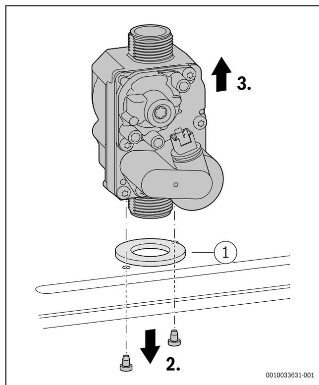
Fig. 69 Démontage du bloc gaz
