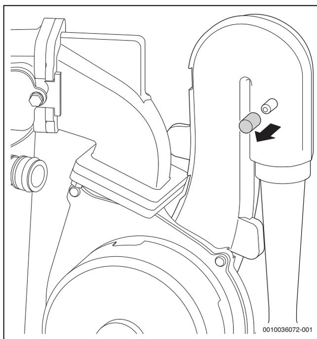
Fig. 45 Raccord de mesure sur le dispositif de mélange
