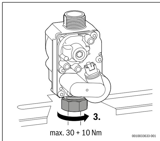
Fig. 71 Respect du couple de serrage
