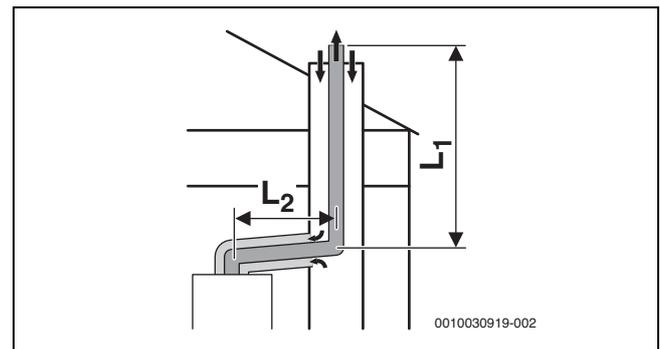
Fig. 10 Evacuation des fumées rigide selon C<sub>93</sub> dans le conduit et circuit d'air et de fumées concentrique dans le local d'installation
