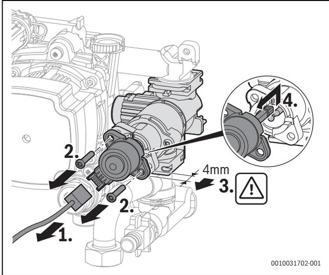
Fig. 76 Démontez le moteur au niveau de la vanne 3 voies (variante avec vis)
