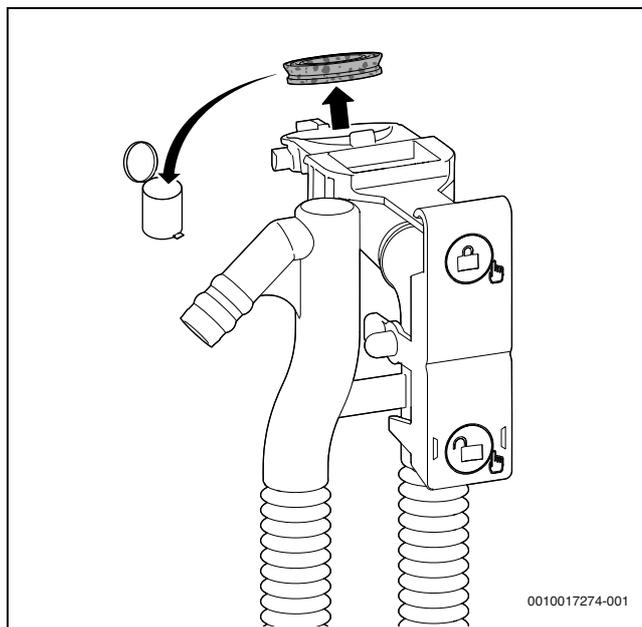
Fig. 60 Retrait du joint en haut sur le siphon de condensats
