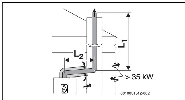
Fig. 12 Evacuation des fumées rigide dans le conduit selon B<sub>33</sub> avec arrivée d'air dépendant de l'air ambiant par le circuit d'air et de fumées concentrique dans le local d'installation
