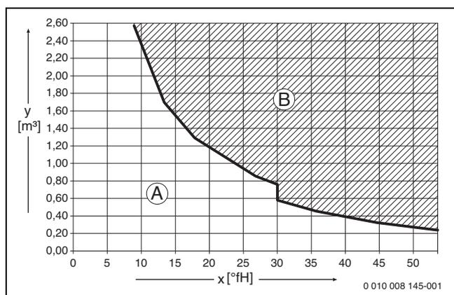
Fig. 20 Conditions requises pour l'eau de remplissage et d'appoint en °fH sur les appareils < 50 kW
