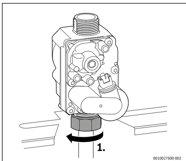
Fig. 68 Desserrage de l'écrou
