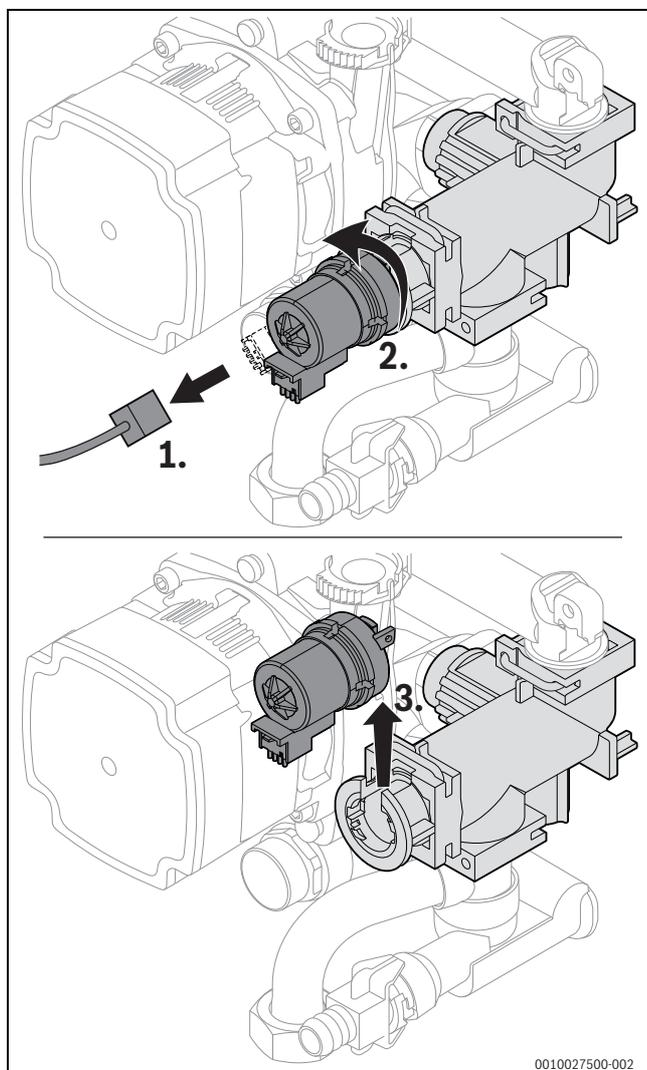
Fig. 74 Démontez le moteur au niveau de la vanne 3 voies (variante sans vis)
