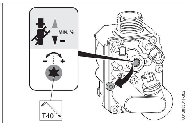
Fig. 41 Régler la teneur en CO<sub>2</sub> ou en O<sub>2</sub> pour la puissance thermique nominale minimale, vanne gaz ajustable
