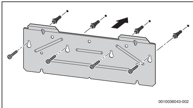
Fig. 23 Montage de la traverse d'accrochage
