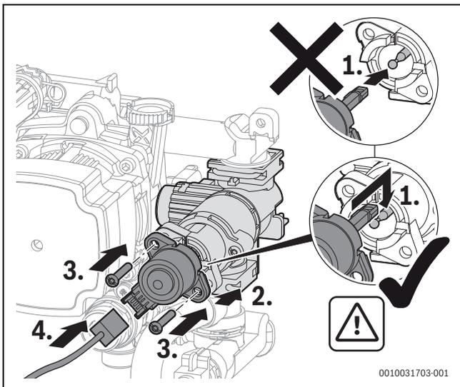
Fig. 77 Remontez le moteur au niveau de la vanne 3 voies (variante avec vis)
