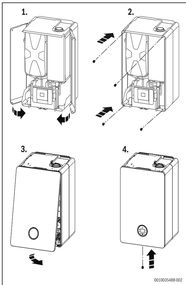
Fig. 35 Montage du carénage
