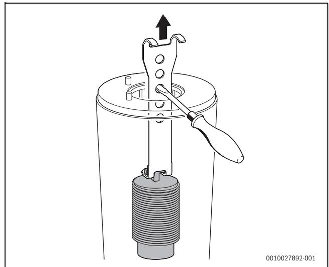
Fig. 52 Retirer le corps de déplacement inférieur
