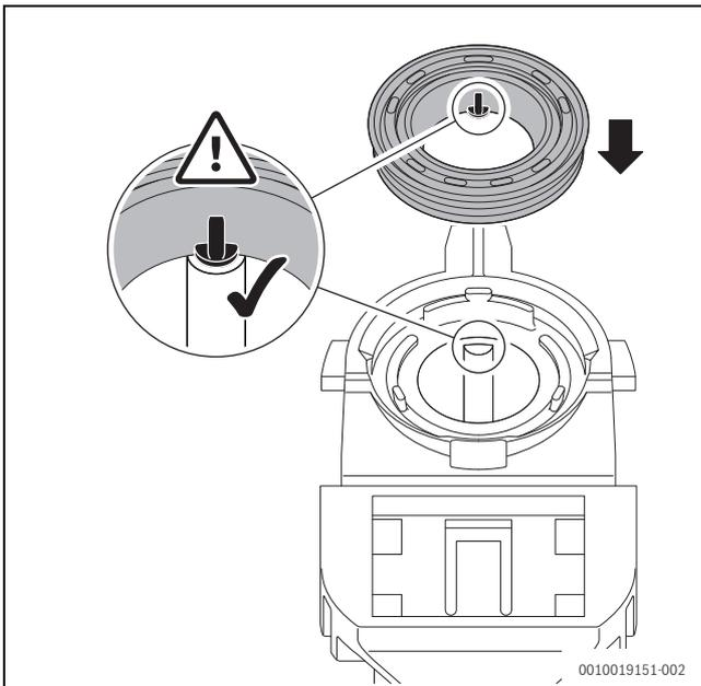
Fig. 61 Alignement du nouveau joint sur le siphon de condensats
