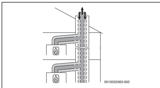
Fig. 16 Raccordement de plusieurs foyers selon C<sub>(10)3</sub> avec circuit d'air et de fumées concentrique dans le local d'installation
