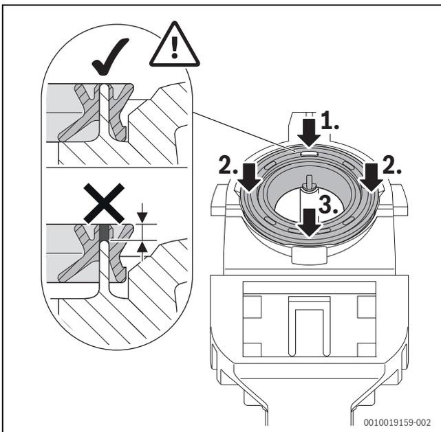
Fig. 62 Appui sur le joint
