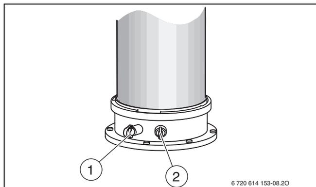
Fig. 44 Buse de mesure des fumées et de l'air de combustion
