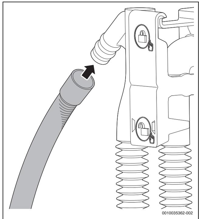
Fig. 26 Monter le tuyau des condensats sur le siphon de condensats.
