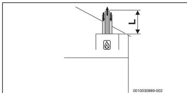
Fig. 9 Circuit d'air et de fumées vertical concentrique selon C<sub>33</sub>
