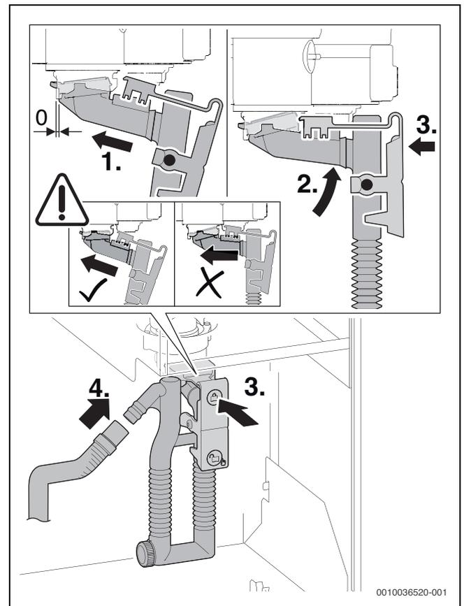
Fig. 63 Insertion du siphon de condensats
