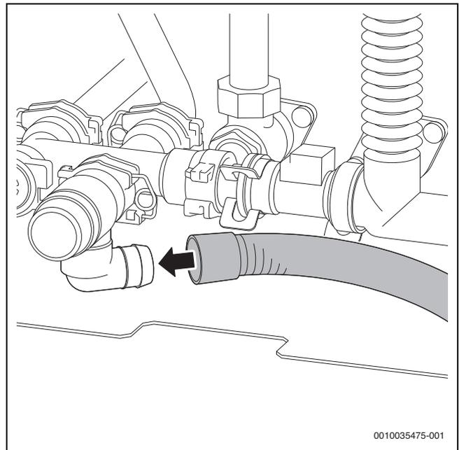
Fig. 25 Montage du tube sur la soupape de sécurité (circuit ECS)
