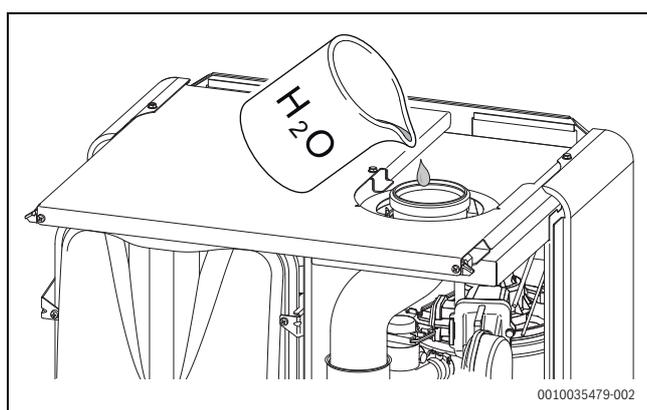
Fig. 28 Remplir le siphon des condensats avec de l'eau
